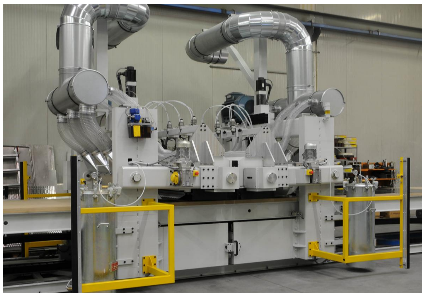
Exemplo da Configuração com Mesa Móvel e montante de lustração fixo (chapas de até 5.000 mm)
