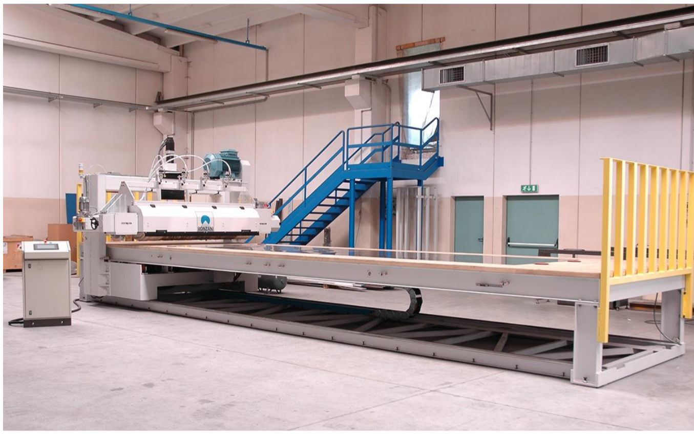
Exemplo da Configuração com Mesa Fixa e montante de lustração móvel (chapas de até 12.500 mm)
