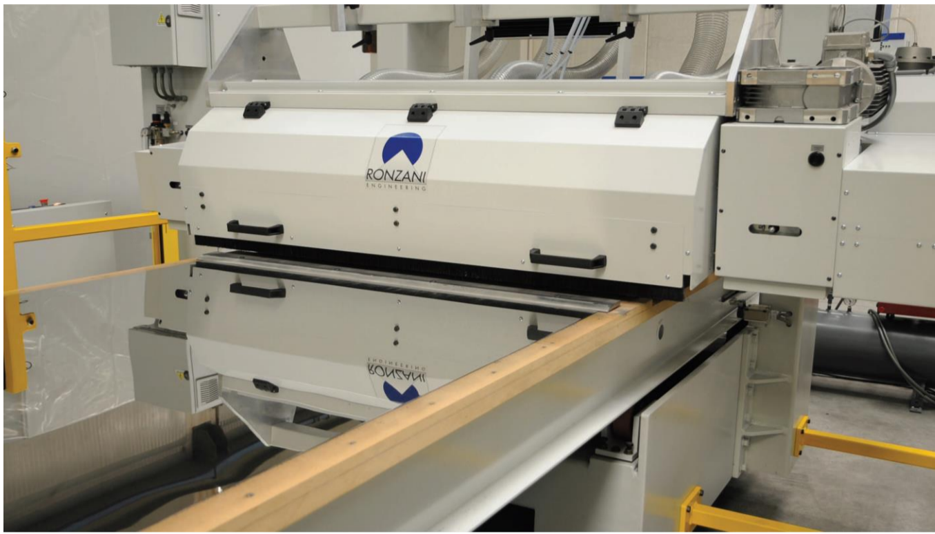
Exemplo da Configuração com Mesa Fixa e montante de lustração móvel (chapas de até 12.500 mm)
