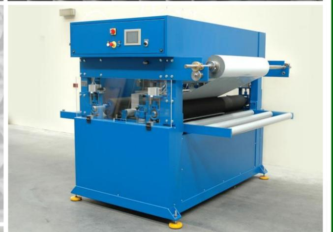
Qualquer das configurações de máquinas podem trabalhar com ou sem bancada de roletes de apoio, para carga e descarga, podendo ser dotada de **equipamentos para a movimentação da chapa, de corte automático de filme de proteção, de equipamentos de exaustão e ventilação para a limpeza e refrigeração da chapa.**
