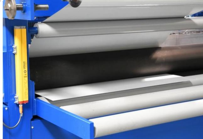
As séries "de Rolos" e "Combi" têm a possibilidade de operar também com a unidade de **aplicação de filme de proteção** em dois modos: 1) contemporaneamente à operação de floreado; 2) apenas como plastificadoras de chapa.
