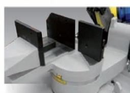
O conjunto de fixação corre transversalmente sobre a placa para realizar o corte em ângulo para a direita e para a esquerda.
