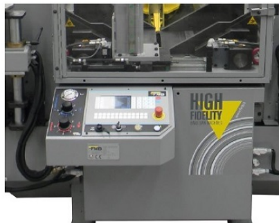
Panel de comando touch screen Siemens
