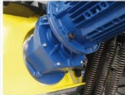
Redutor engronado com dentes inclinados cementados retificados e lubrificados com graxa de longa vida. O eixo de entrada é de aço ligado, cementado e temperado e o de saída é de aço bonificado. O rendimento deste redutor é de 95%, enquanto que o de um redutor tipo fuso sem fim utilizado pela concorrência é de 55%
