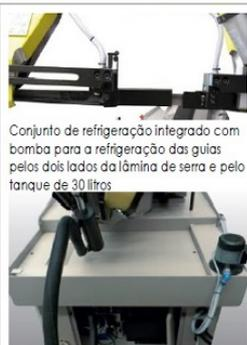
Conjunto de refrigeração integrado com bomba para a refrigeração das guias pelos dois lados da lâmina de serra e pelo tanque de 30 litros
