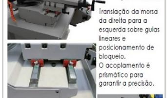
Translação da morsa da direita para a esquerda sobre guias lineares e posicionamento de bloqueio. O acoplamento é prismático para garantir a precisão.
