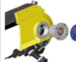
**Volante do motor:** conjunto flange composto por rolamentos cônicos contrapostos, para preservar o moto redutor das forças causadas pelo tensionamento da lâmina, garantindo o alongamento de vida útil.
