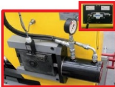
TI - Tensionador hidráulico da lâmina de corte Permite efetuar a "puxada" da lâmina de forma correta. Quando a máquina é desligada, a lâmina é relaxada automaticamente, evitando um inútil trabalho elástico
