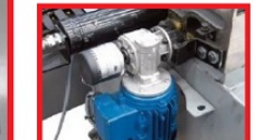
O CNC permite a exibição da posição de feedback e de seu movimento automático pelo motoredutor
