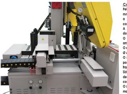
Conjunto de translação Pelo lado de carga: bancada de 8 rolos (1100 mm) para apoiar o material, posicionada sobre a base e independente do sistema de comento da morσα de avanço de material. A morσα do carro de avanço do material é dotada de cilindro hidráulico. O conjunto é integrado com um dispositivo anti-atrito para barras não retas. O comento é feito sobre guias cromadas com Ø 60 mm e curso de avanço de 420 mm. O sistema de medição é feito com batente de posicionamento automático, sobre fuso trapezoidal e encoder. Sistema com duplo sensor para a desaceleração e parada da morσα do carro com tolerância de posicionamento de 0,2 mm. O sensor de falta de material é colocado na morσα do carro de avanço.
