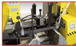
MV-PO Morσα vertical e acionamento hidráulico, com posicionamento manual para produção em série (pacotes). Trabalha simultaneamente com a morσα de fixação de material, garantindo a estabilidade de pacotes
