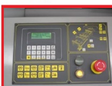
Painel de controle simples e intuitivo, dotado de amplo monitor que controla as funções da máquina, programação de ciclo de corte e função de autodiagnóstica
