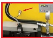
O sensor eletrônico SENS (foto ao lado) que verifica a rotação, se houver tensão excessiva, ou se a lâmina não estiver tensionada corretamente, intervém interrompendo a rotação e evitando a quebra da lâmina.
