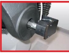
Encoder de memorização para a fixação do arco em posição de corte
