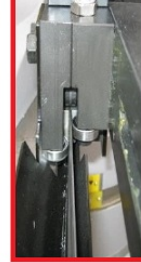
O sensor eletrônico SENS (foto ao lado) que verifica a rotação, se houver tensão excessiva, ou se a lâmina não estiver tensionada corretamente, intervém interrompendo a rotação e evitando a quebra da lâmina.
