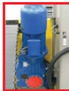
Conjunto motoredutor do arco: Redutor de eixos paralelos com eixo de ingresso e engrenagens especiais ligadas, endurecidas, revenidas e retificadas.
