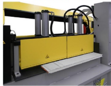
Corte de Painel Sanduiche
