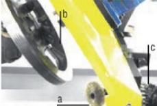
Redutor com eixo árvore portante e ímã de manutenção (graxa). Eixo de saída do redutor com Ø de 40 mm e fixação do volante do motor com encaixe de alítra
