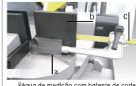
Régua de medição com batente de corte de 0 a 600 mm
