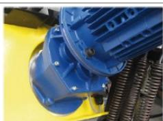
Redutor engrenado com dentes inclinados cementados retificados e lubrificados com graxa de longa vida. O eixo de entrada é de aço ligado, cementado e temperado e o de saída é de aço bonificado. O rendimento deste redutor é de 95%, enquanto que o de um redutor tipo fuso sem fim utilizado pela concorrência é de 55%
