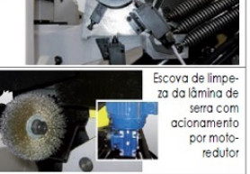
Escova de limpeza da lâmina de serra com acionamento por motoredutor
