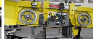
RM Bancada motorizada para alimentação de barra para frente/para trás
