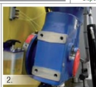
2. Motoredutor direto no eixo da fita
