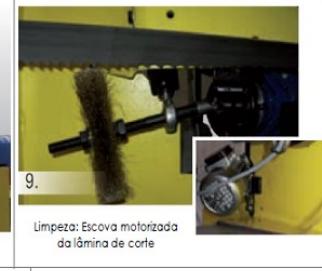
Limpeza: Escova motorizada da lâmina de corte
