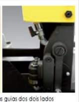
Lubrificação nas guias dos dois lados
