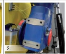
Motoredutor direto no eixo da fita
