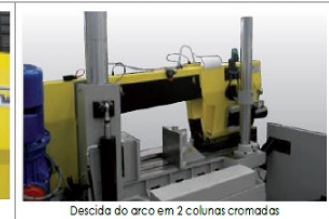
Descida do arco em 2 colunas cromadas
