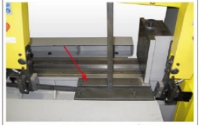
Suporte adicional entre a morsa e a lâmina de corte
