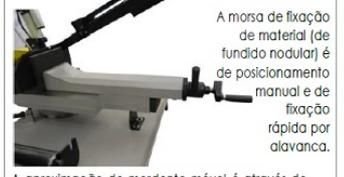
A morsa de fixação de material (de fundido nodular) é de posicionamento manual e de fixação rápida por alavanca. A aproximação do mordente móvel é através de fuso trapezoidal (com sistema de corrimento superficial). O acoplamento é prismático para garantir a precisão. Dotado de mordente de apoio para sustentar material na saída.
