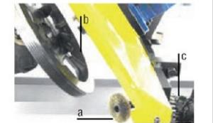
Motor de acionamento da lâmina de corte
