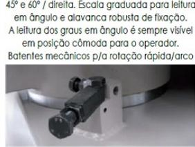
A alavanca de bloqueio/desbloqueio do arco para cortes em ângulo é muito prática.
