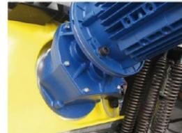
Redutor engranado com dentes inclinados cementados retificados e lubrificadas com graxa de longa vida. O eixo de entrada é de aço ligado, cementado e temperado e o de saída é de aço bonificado. O rendimento deste redutor é de 95%, enquanto que o de um redutor tipo fuso sem fim utilizado pela concorrência é de 55%
