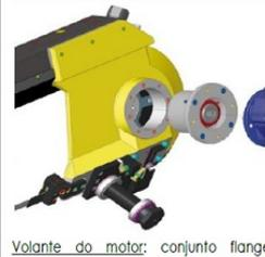
Volante do motor: conjunto flange composto por rolamentos cônicos contrapostos, para preservar o moto redutor das forças causadas pelo tensionamento da lâmina, garantindo o alongamento de vida útil.
