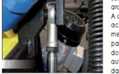
Sensor de ruptura da lâmina. A tensão da lâmina é ajustável: um sistema dinâmico assinala de modo visual e imediato o ponto do valor de tensão correto para a fita.
