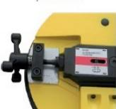
Conjunto guias da lâmina de corte: ação combinada de rolamentos verticais desfasados para o primeiro endireitamento + 2 placas e widia (20x20mm) reguláveis para a contenção + um anel rotatório de metal duro sobre a dorsal da lâmina para o contraste da força de corte necessária para aumentar a vida da lâmina em relação a um contraste de aço.
