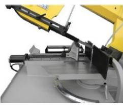
Régua de medição com batente de corte de 0 a 600 mm
