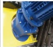
Redutor engranado com dentes inclinados cementados, retilificados e lubrificados com graxa de longa vida.
