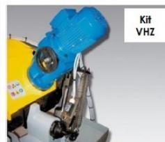
Tensionamento da lâmina de corte ajustável, através de um sistema com dinâmometro, que assinala o ponto de justa tensão para a fita.
