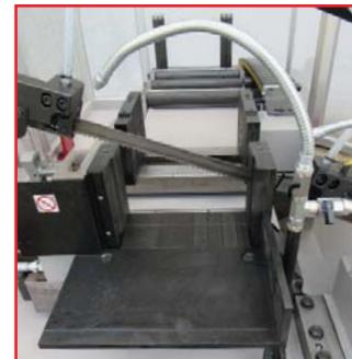
Avvicinamento della ganascia mobile tramite una vite trapezoidale che garantisce un sistema di manovra scorrevole ed efficiente anche ad elevati carichi.
