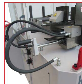
Morsa chiusura materiale in ghisa a posizionamento manuale, dotata di cilindro di chiusura idraulico.
