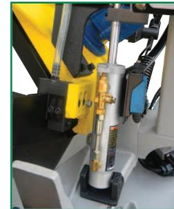
Cilindro idraulico per regolare la velocità di discesa dell'arco durante l'uso in modalità gravitazionale.
