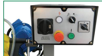
Quadro elettrico con comandi ausiliari a 24V AC protetto contro le correnti magnetiche e termiche. Interruttore principale lucchettabile. Interruttori per la scelta della velocità di rotazione della lama (35-70 m/min) e del tipo di uso (manuale/gravitazionale).
