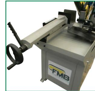
Morsa di bloccaggio materiale, ruotando il volantino si avvicina la morsa al pezzo in modo preciso e graduale. La leva permette di bloccare e sbloccare rapidamente il pezzo.
