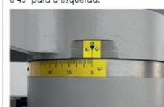
A leitura graduada para os ângulos de corte é sempre visível em posição cômoda ao operador. Dotada de batentes mecânicos para a rotação rápida de 0° a 60°
