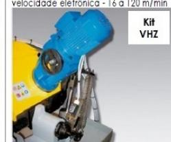
Tensionamento da lâmina de corte ajustável, através de um sistema com dinâmometro, que assinala o ponto de justa tensão para a fita.
