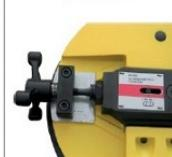
Conjunto guias da fita de corte: ação combinada de rolamentos verticais desfasados para o primeiro endireitamento + 2 placas e widia (20x20mm) reguláveis para a contenção + um anel rotatório de metal duro sobre a dorsal da lâmina para o contraste da força de corte necessária para aumentar a vida da lâmina em relação a um contraste de aço.
