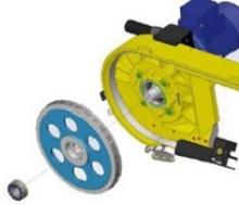
Redutor engrenado com dentes inclinados cementados reforçados e lubrificados com graxa de longa vida. O eixo de entrada é de aço ligado, cementado e temperado e o de saída é de aço bonificado. O rendimento deste redutor é de 95%, enquanto que o de um redutor tipo fuso sem fim utilizado pela concorrência é de 55%
