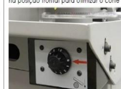
A rotação do arco é feita através de batentes em 0°, 45° e 60° para a direita e 45° para a esquerda.
