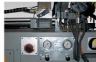
Regulador de pressão para a fixação da morsa de corte e da morsa do carro
