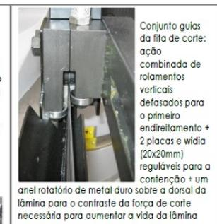
Conjunto guias da fita de corte: ação combinada de rolamentos verticais defasados para o primeiro direcionamento + 2 placas e widia (20x20mm) reguláveis para a contenção + um anel rotatório de metal duro sobre a dorsal da lâmina para o contraste da força de corte necessária para aumentar a vida da lâmina em relação a um contraste de afito.
