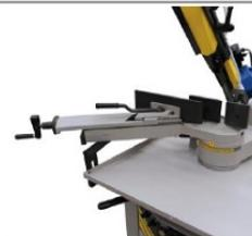
Conjunto MORSA Sólida morsa de fixação (fundido nodular) com inclinação de 45° para a esquerda, de posicionamento manual e sistema de fixação rápida:
