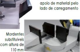
A estrutura da máquina é robusta, produzida de caldeiraria com chapas grossas diferenciadas, com suas laterais adequadas a contenção de cavacos.
