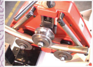
Stazione di curvatura (vedi "Caratteristiche Tecniche") Tube bending station (see "Technical Features") Cintrage tubes (voir "Caractéristiques Techniques") Ringbiegestation (siehe "Technische Eigenschaften") Estación de curvatura (véase "Características Técnicas")
