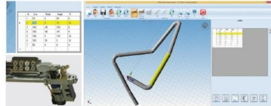
EASY PROGRAMMING 4 é o novo software de programação gráfica tridimensional da OMCG para máquinas dobradoras CNC para arame, tubo e tira metálica. É um software intuitivo, de fácil utilização, com base em computadores industriais fanless com SSHD e sistema operacional Windows 10 que, em termos de produtividade e de segurança operacional, se diferencia dos concorrentes graças a:
