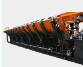
Alavancas inferiores super estruturadas com um ângulo de rotação até um máximo de 145 graus.
