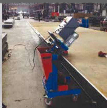
SMUSSO SU LAMIERA BEVEL ON METAL SHEET
