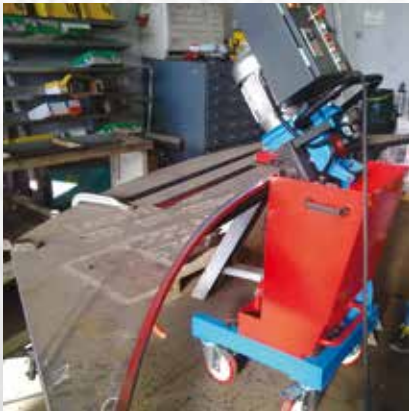
SMUSSO SU RAGGIO INTERNO BEVEL ON INTERNAL RAY
