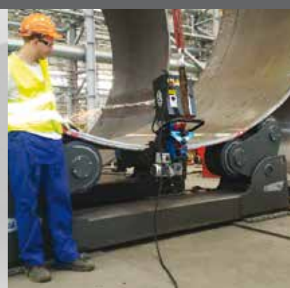
SMUSSO INTERNO TUBO BEVEL ON INTERNAL PIPE
