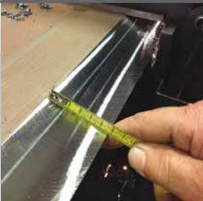
SMUSSO SU RAGGIO INTERNO BEVEL ON INTERNAL RAY
