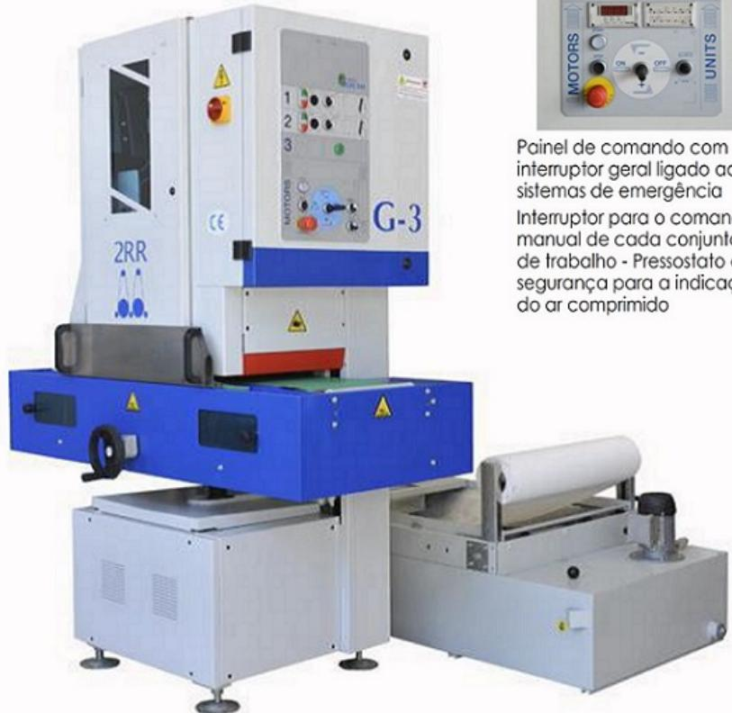
Painel de comando com interruptor geral ligado aos sistemas de emergência
