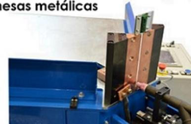
Fabricada em estrutura robusta soldada com guias para suporte e movimentação da tocha de solda, com sistema automático para a fixação das peças.
