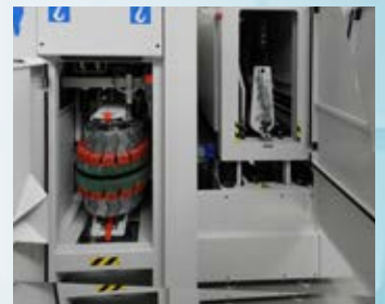
1 Grupo R de cinta abrasiva + 1 Grupo CS con cepillos de scotch brite 1 Unidade R lixa + 1 unidade CS escova de scotch brite
