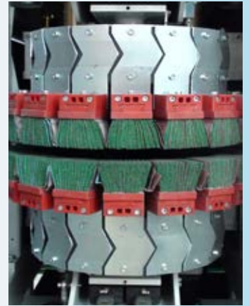
Cinta abrasiva mixta con cepillos de scotch brite Escova mistas de tela abrasiva e scotch brite
