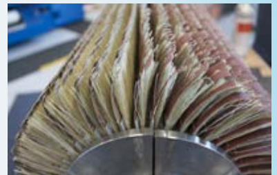
Unidad de cepillo barril para desbarbado ligero Escova para a remoção de rebarbas leves
