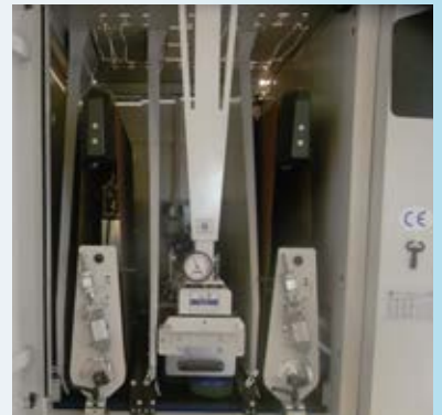
2 Unidades de cinta abrasiva + 1 unidad con cepillos 2 conjuntos lixa + 1 conjunto escova top
