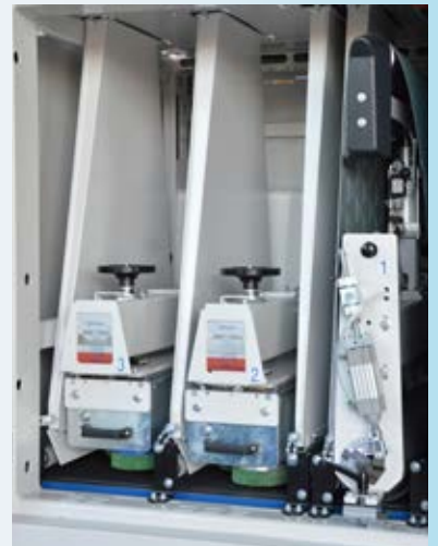
Grupos RTT - 1 Unidad de cinta abrasiva + 2 Unidades con cepillos Conjunto RTT - 1 unidade lixa + 2 unidades escovas top
