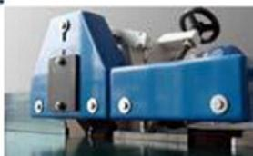
**Chanfro-esmerilhadeira idealizada para chanfrar peças lineares, cortados por guilhotina, puncionadeira com microjunção, plasma e laser. Realiza numa única passada os chanfros em ambas as faces da peça.**
