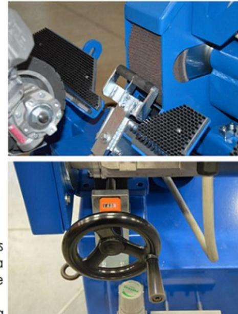
Escovadora, politriz industrial para tubos com motor autorenante, de duas velocidades, com escova com regulagem manual através de volante (para a compensação do desgaste). O rolo de contraste é emborrachado com sistema de inclinação para regular o diâmetro a ser trabalhado.
