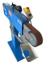
A máquina foi concebida para as operações de polimento e esmerilhamento por roda de contato.
