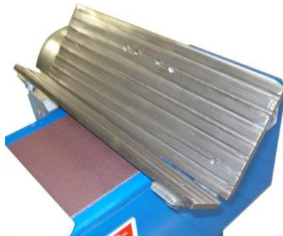
Durante o processo, a lixa corre sobre uma superfície de tela de grafite, que torna o trabalho mais macio e homogêneo permitindo, tornar a bancada ainda mais macia pela interposição da camada esponjosa entre a base metálica e a tela de grafite. Desta forma a lixa adapta-se às deformações da peça obtendo resultados ótimos de acabamento.
