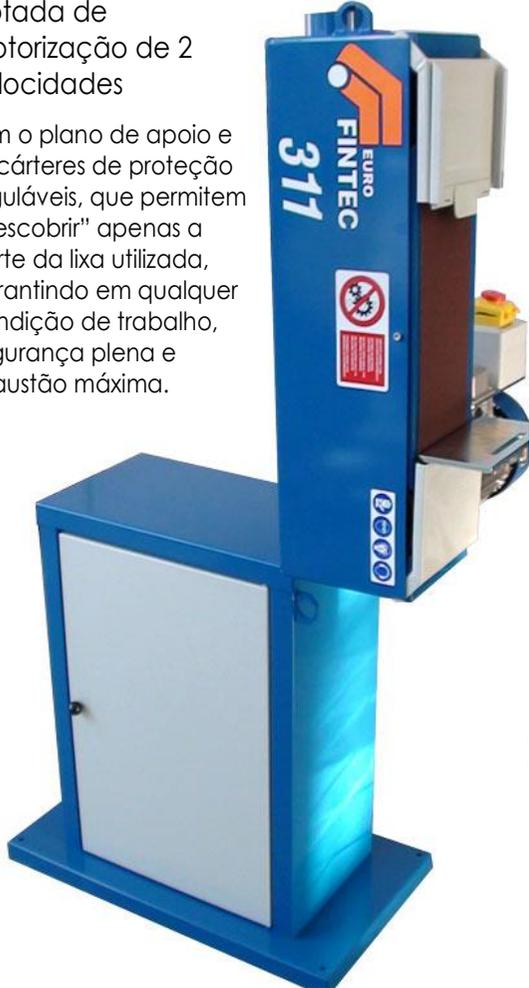
A bancada, é equipada com um prático suporte regulável, sendo protegida por proteções móveis que permitem expor apenas a parte da lixa usada no processo de produção como também pode trabalhar completamente aberta para permitir o processo de peças longas em passada, mantendo a proteção máxima.
