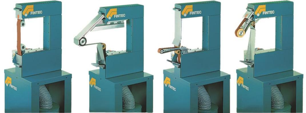
Máquina especial para remover sobras de fundição e para a lustração de peças irregulares de peças fundidas e forjadas
