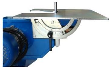
A base de apoio é inclinável de -15° a +60° e removível. O plano de corrimento da lixa é substituível com outros com perfis adequados a cada tipo de serviço.
