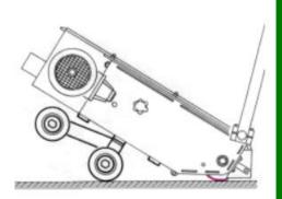
As rodas do carrinho podem ser posicionadas em mais pontos, sendo que as posteriores podem ser pivotantes.
