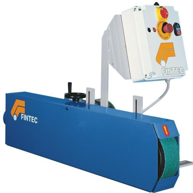
A roda de contato é emborrachada com estrias, permitindo o desbaste máximo pelo melhor aproveitamento da lixa.
