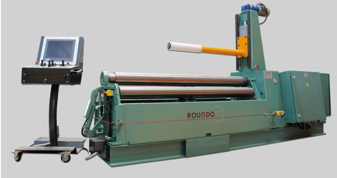
Série PASS → Calandras com Ø do rolo superior de 110 a 310 mm
