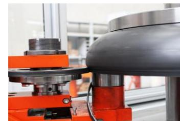
A rifilo-rebordadeira completa a operação da formação da peça realizando o esquadrejamento para o acoplamento da calota com o corpo do extintor.
