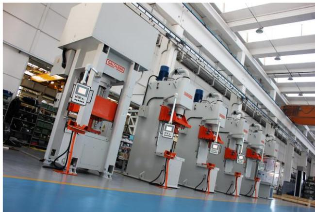
Esta linha ‘turn-key’ se destaca pela altíssima produtividade e confiabilidade mesmo em altas cargas ininterruptas. A linha é composta por 5 prensas de **63 e 70 tons** com alimentação e avanço das peças totalmente automáticos.
