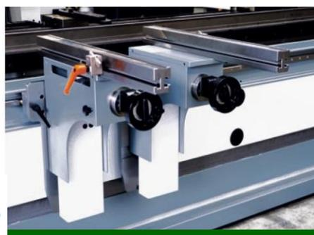
Suportes frontais móveis, montados sobre guia linear, reguláveis em altura através de volante, com régua milimetrada. Dotados de batentes e estacionamento lateral
