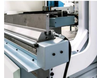
Fixação pneumática de punção e matriz
