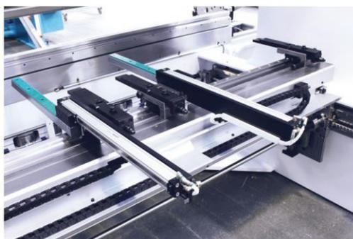
Posicionador posterior rápido com fusos de recirculação de esferas retificadas comandado p/ CNC. Versatilidade completa com possibilidade dos seguintes eixos:
