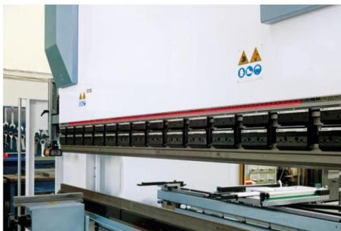
Led de posição das ferramentas e eixos Z1 – Z2. A luz do led indica onde posicionar a ferramenta necessária e mostra a sequência das estações de dobra programadas
