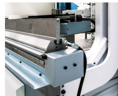
Fixação pneumática de punção e matriz
