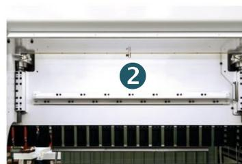
② Vista do dispositivo para garantir a constante rigidez e linearidade do martelo e da barra do posicionador posterior
