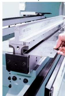
Dispositivo de medição a laser para o cálculo do ângulo Data-M
