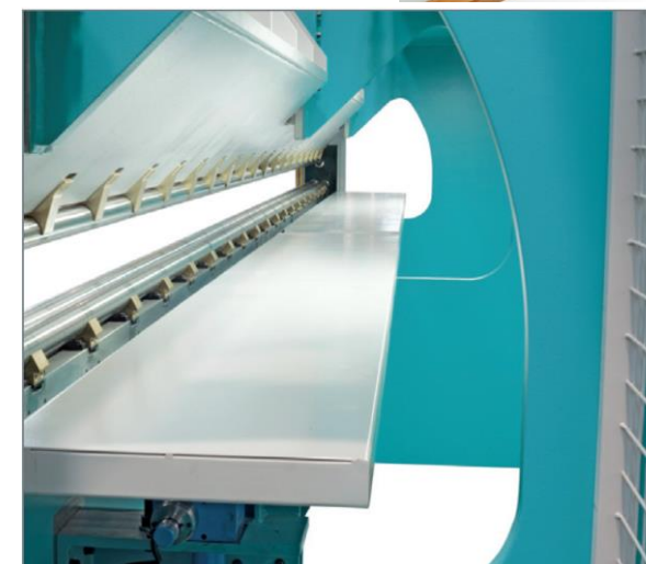
Mesa posterior com comando pneumático ou eletromecânico comandada por CNC
