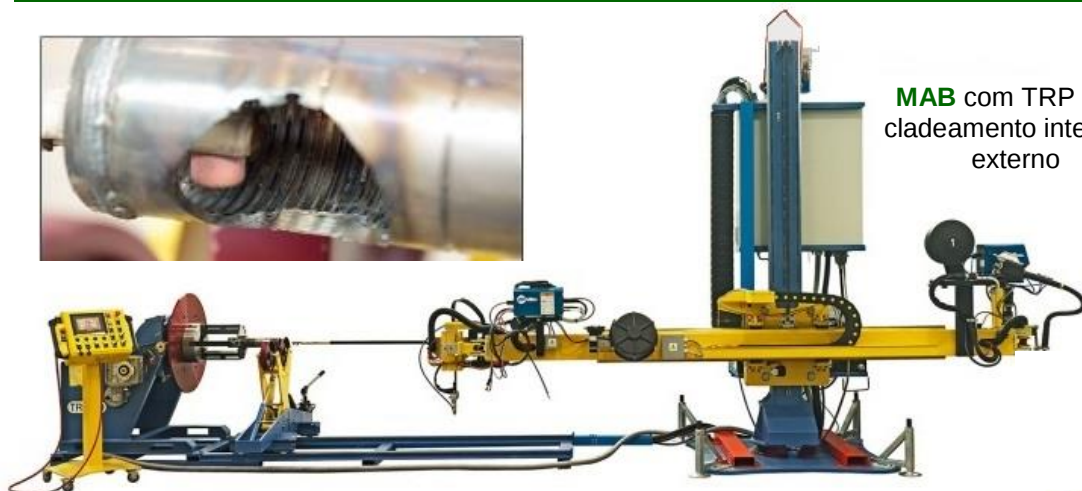
Equipamento especial para a solda de flange em MIG/MAG com apalpador mecânico
