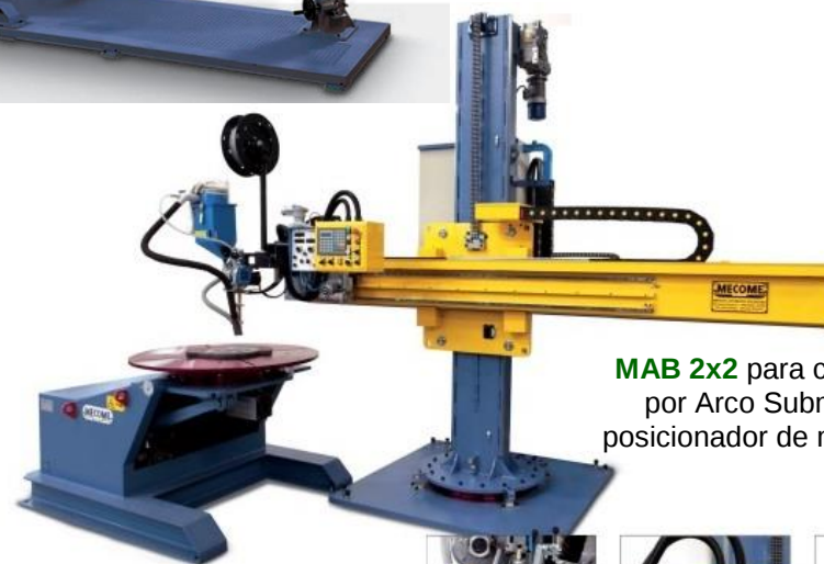
MBL 1,5x1,5 com solda TIG + AVC + posicionador especial
