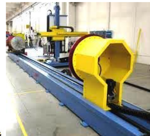
MBL 1,5x1,5 com solda TIG + AVC + posicionador especial
