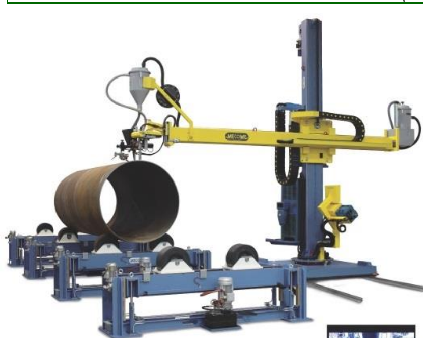
MAB 4X4 SAW com viradores de solda com elevação motorizada
