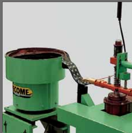
Terminale di alimentazione con braccio rotante di presa e movimentazione pezzo.
