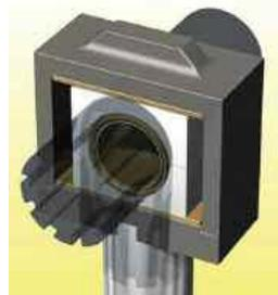
Mecanismo biela manivela composto de um patim que recebendo o movimento do botão da biela (excêntrico do eixo-árvore) transforma o movimento do rotatório em modo alternado agindo sobre o cilindro da guia com eliminação das forças laterais.
