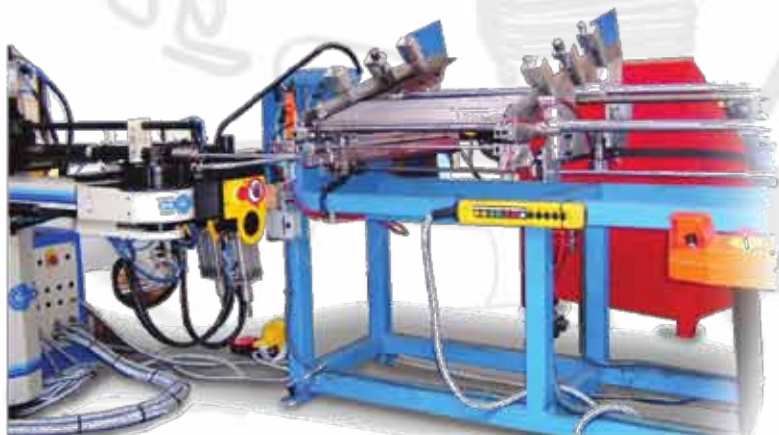
CURVATUBI CON CARICATORE AD IMPILATORE CON PRELIEVO VERGA
