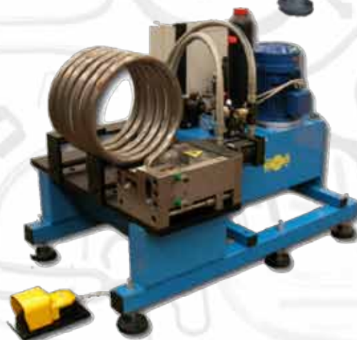
Unità di taglio a coltello a doppio passaggio Unité de coupe à lame à double passage
