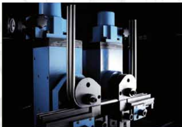
Curvatura multipla 2-3 tubi Cintrage simultané de 2, voir 3 tubes
