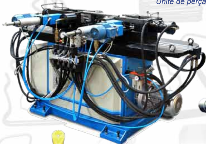
Unità di foratura e maschiatura Unité de perçage et taraudage
