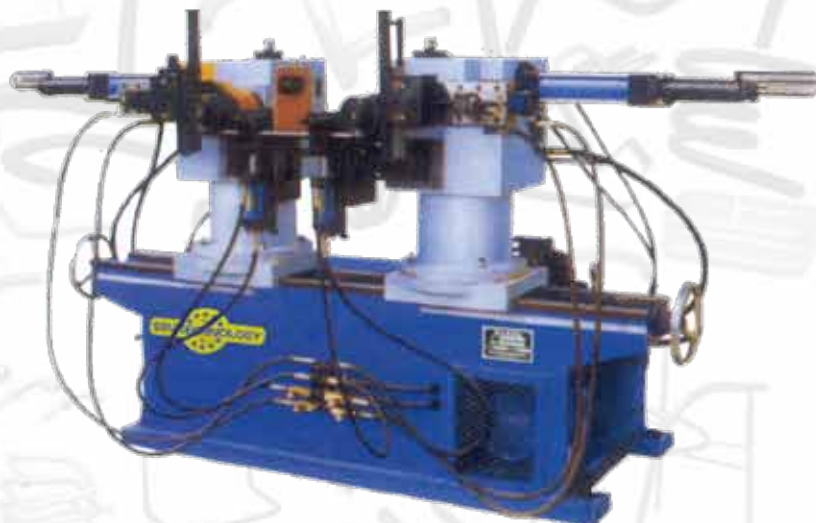
Cintreuse 1 axe CNC avec possibilité de rotation des têtes à 90°
