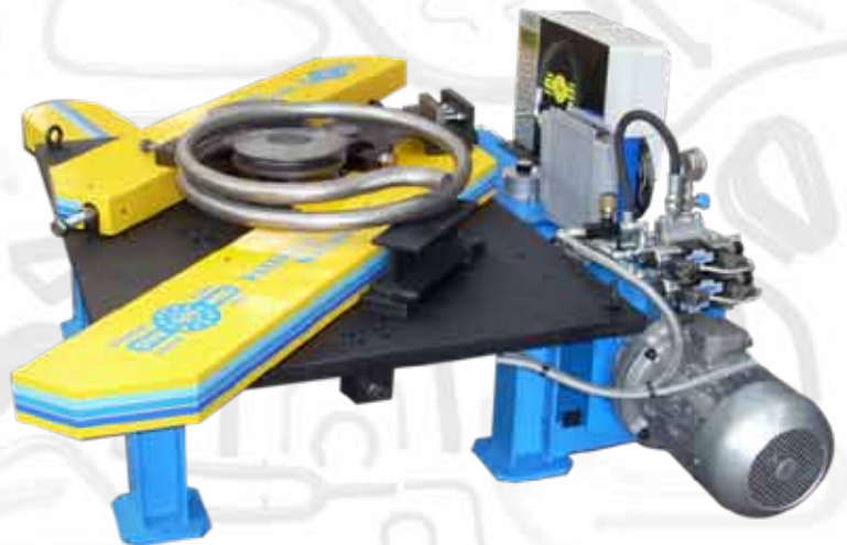
Curvatubi con curvatura contrapposta con doppia curva in unico ciclo di curvatura Cintreuses avec cintrage opposé à double cintre en une seule phase de travail
