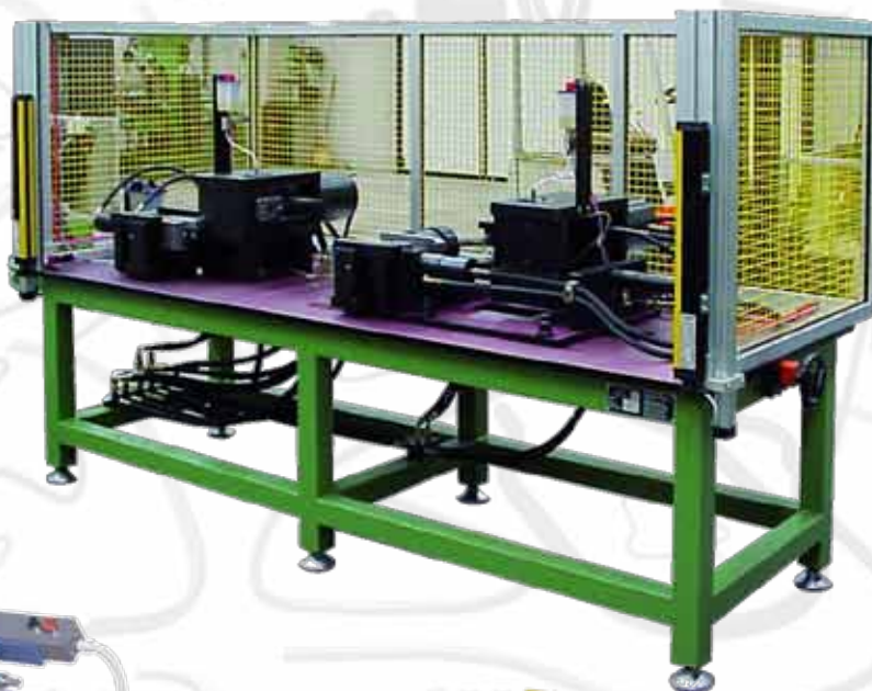
Banco di lavorazione multiple foratura e rastrematura etc. etc. Bancs de travaux multiples poinçonnage et retreint
