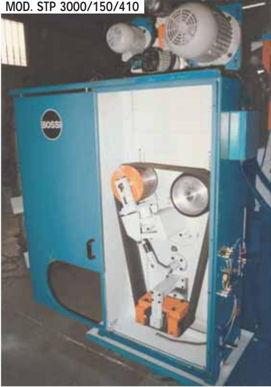
Sono illustrati vari modelli di unità per la scordonatura di tubi inox. Si tratta di unità per tubi grossi (max. Ø mm. 410), unità a colonna e unità a spazzola (usate principalmente per spazzolatura con ruota lamellare su linee H.F.) che completano una gamma unica sul mercato.
