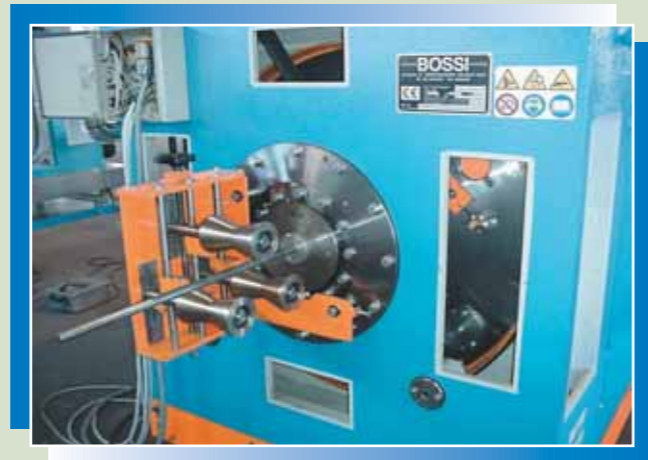
Mod. SP 350/600-168: • Particolare gruppo guida tubo. • Detail of tube driving group. • Detail des Rohrführungsaggregats. • Détail du groupe guide-tube.
