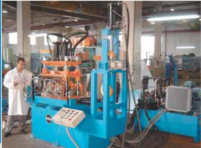
Macchina estremamente veloce ed adatta ad essere inserita su una profilatrice per tubi in acciaio inox con sistema di saldatura al laser. Le sue dimensioni ridotte permettono l'installamento anche su profilatrici trasformate da TIG a LASER. Frutto di anni di esperienza nel settore del tubo inox, questo modello va ad arricchire la nostra gamma di macchine per la lavorazione "in linea". Per i dati tecnici vedere la tabella a pagina 13.
