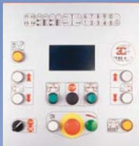
Curvatrice equipaggiata con controllo **CN111** lavora in multipassata controllata elettronicamente da un microprocessore, gestibile in modo manuale, semiautomatico e automatico con possibilità di interrompere il ciclo di lavoro per le verifiche. Il software installato gestisce curve monoraggio oppure curve con tre raggi assicurando una corretta ripetitività delle esecuzioni e la possibilità di memorizzare fino a 199 programmi diversi in monoraggio e 19 in multiraggio.
