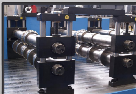
Detalhe dos rolos de conformação
