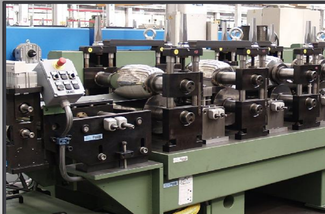
Detalhe da perfiladeira
