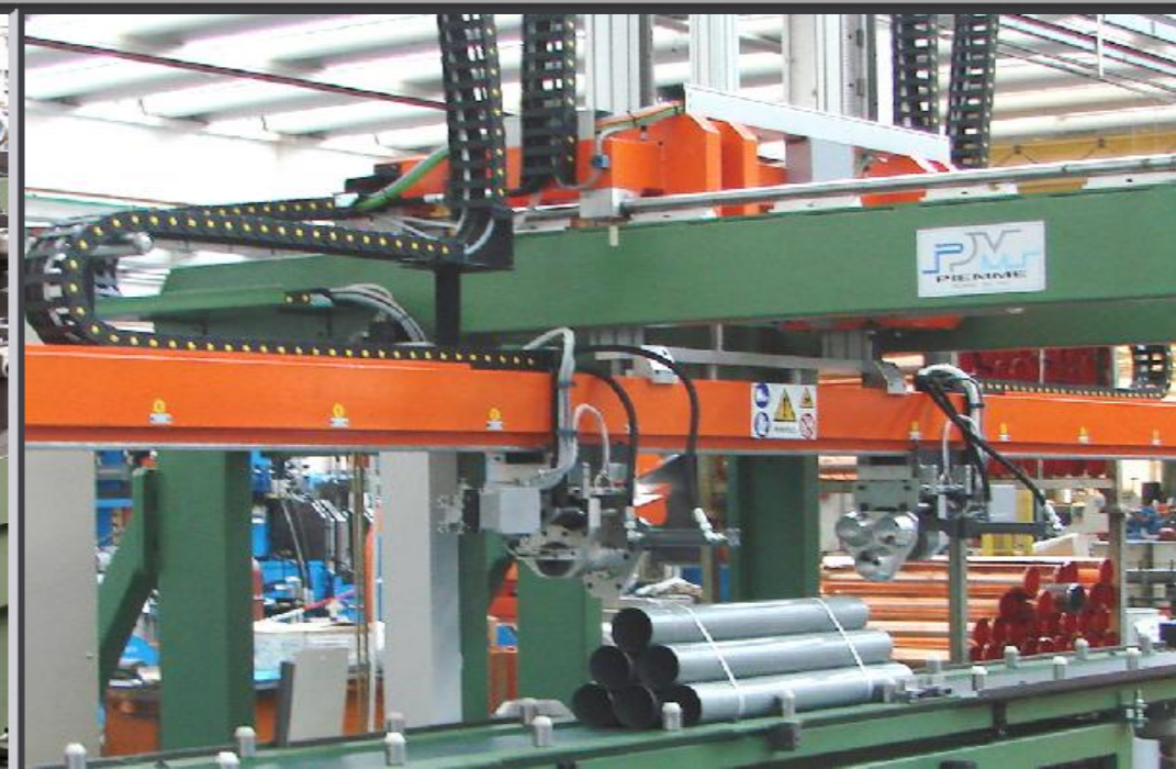
Detalhe do transfer de empilhamento de pacotes
