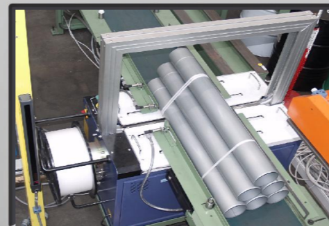
Conjunto de cintagem automática
